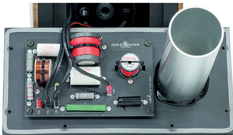
Il filtro crossover è realizzato con componenti che ormai sono diventati quasi uno standard su diffusori acustici di elevata classe. Da notare il buono spessore del condotto di accordo in alluminio.
