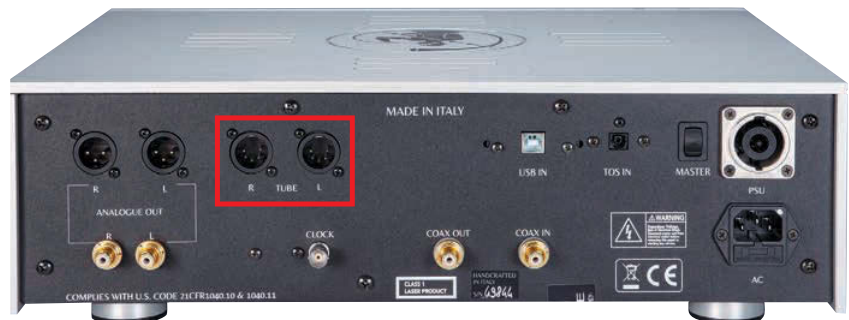
▲ Gute Anschlussvielfalt! Die beiden Fünfpol-Anschlüsse im Rahmen stellen die Verbindung zu den beiden Röhren-Hochpegelstufen her. Die internen Transistoren bleiben dabei aktiv.
