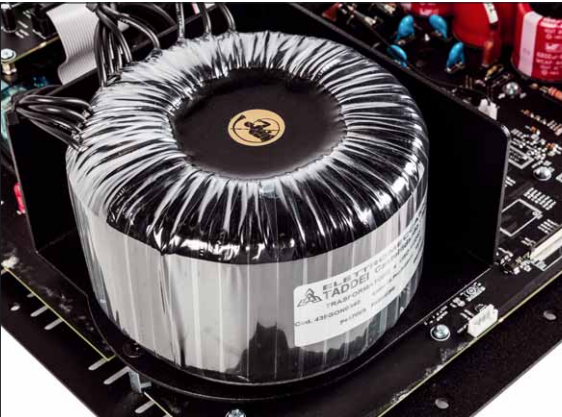
Der kann was: Das Gerät wird von einem mächtigen Ringkerntrafo gespeist
