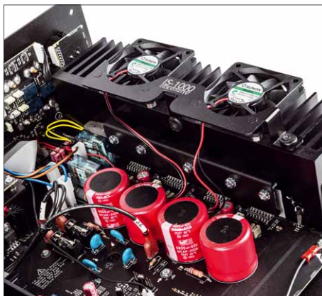
Die Verstärkerschaltung arbeitet mit zwei Chips pro Kanal, die Lüfter sind komplett unauffällig
