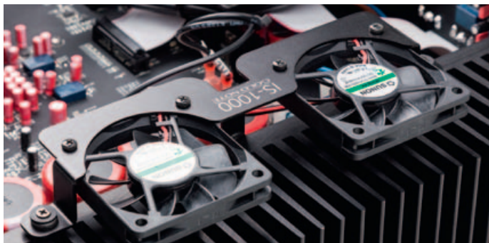
Zwei mit geräuschkämpfenden Gummimuffen montierte Computerlüfter helfen beim Wegschaffen der Abwärme der AB-Endstufen.
