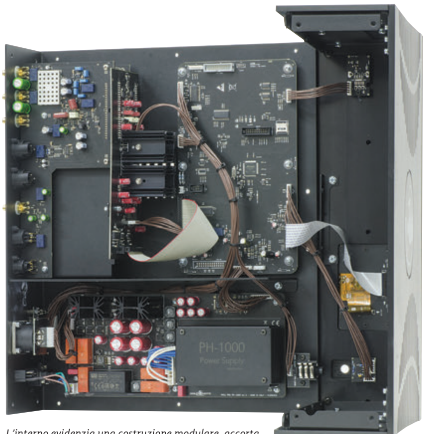
L'interno evidenzia una costruzione modulare, accorta e generosa nel dimensionamento dei componenti, a partire dall'alimentatore, che risulta ulteriormente schermato da una paratia metallica interna.
